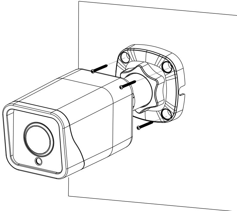
Рис. 11. Монтаж камеры
