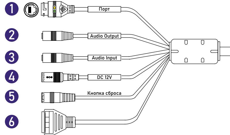
Рис. 1. Подключение кабелей
