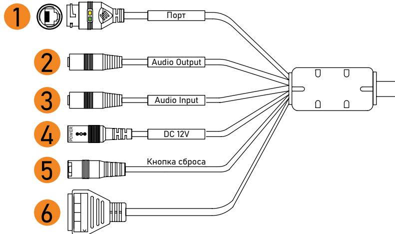
Рис. 25. Подключение кабелей
