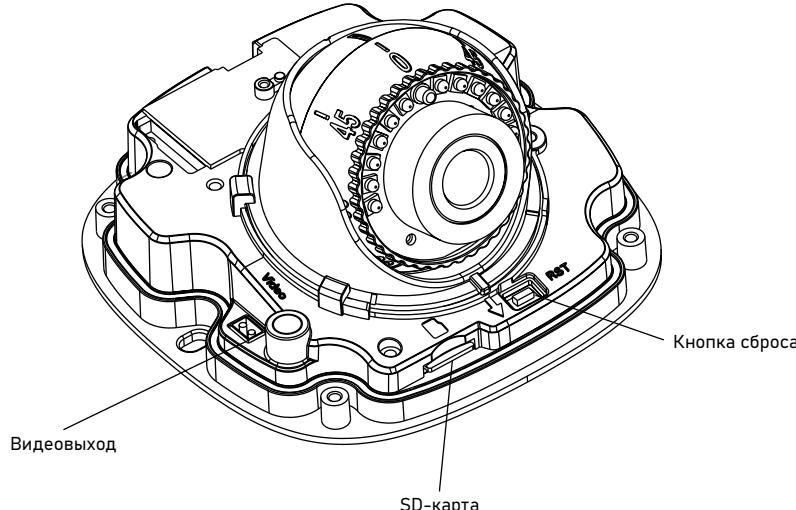
Рис. 26. Подключение кабелей
