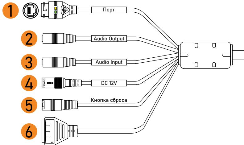
Рис. 13. Подключение кабелей
