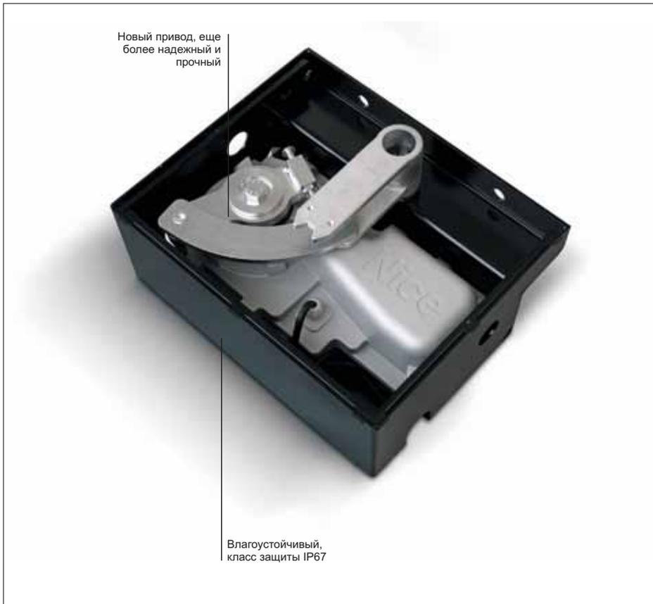
**Для распашных ворот с шириной створки до 5 м, с подземной установкой.** Самоблокирующийся электромеханический привод 24В пост.тока, с магнитным энкодером и механическим упором.
